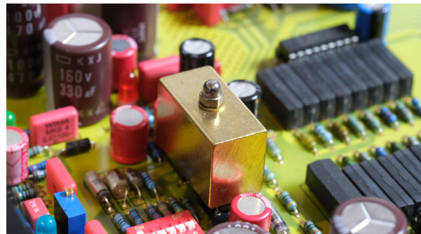
Eine der vielen ungewöhnlichen Detaillösungen: Zur besseren Wärmeableitung, mechanischen Beruhigung und Abschirmung des darunter befindlichen ICs dient ein massiver Messingblock
