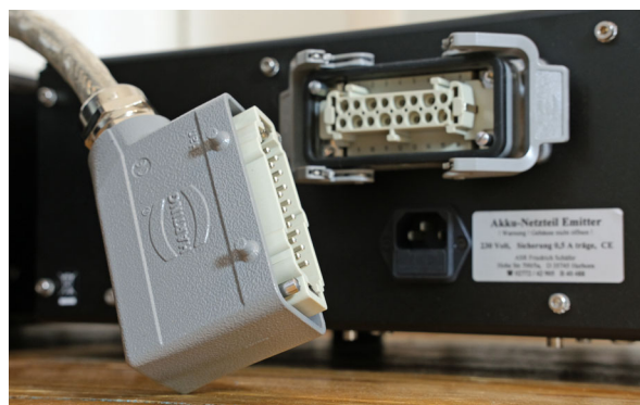
Die Ausgänge der drei externen Netzteile sind mittels Harting-Steckern realisiert
