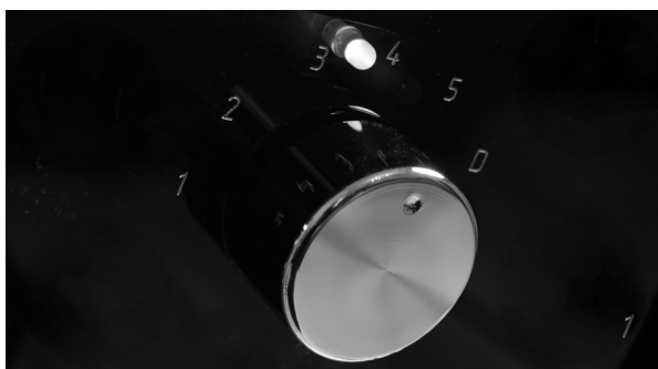
Der Eingangswahlschalter des ASR Emitter II Exclusive: Das „D“ steht für Direkteingang. Das Umschalten erfolgt mit Massentrennung – sowohl Signal- als auch Masseleiter werden geschaltet, was Störeinflüsse nicht aktiver Quellgeräte vermeidet
